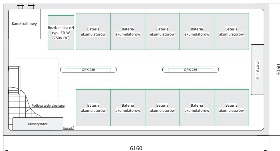
Widok z góry / rozmieszczenie aparatury - część podziemna
